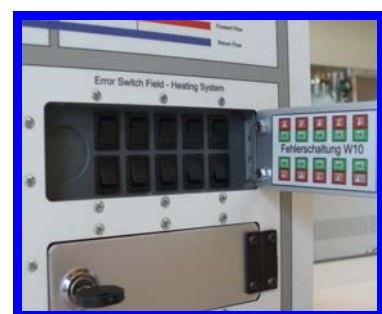
Abschließbare Fehlerschaltung für bis zu 40 Fehler
