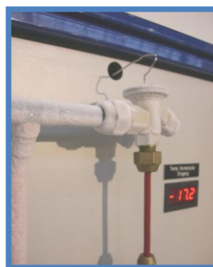
Detail Kältekreis mit Digitalthermometer
